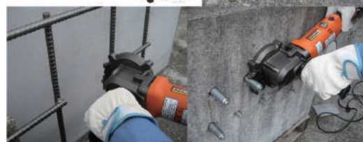
Diamond Cutting saw/齊平切割鋸 是用於鋼筋，螺紋桿，鎖，鏈條，EMT導管等的 多功能切削工具非常適合在表面切割材料
